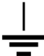
Рисунок 1 – Опознавательный знак заземлителя
