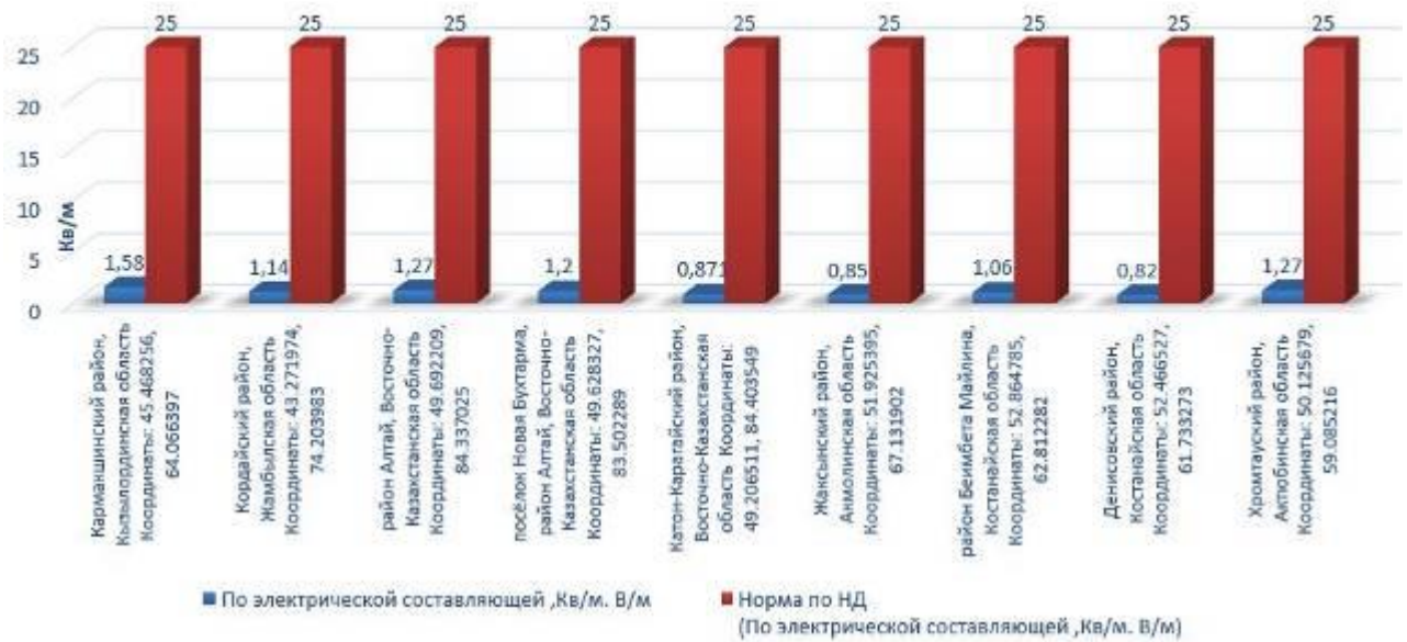
Сурет. 8.1. "Қазақтелеком" АҚ телекоммуникациялық жабдығының электромагниттік сәулеленуін өлшеу нәтижелері (электр компоненті)
